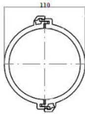
Przykładowa rura osłonowa HDPE SN8 średnicy 110 mm koloru niebieskiego dla kabli NN
