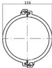
Przykładowa rura osłonowa HDPE SN8 średnicy 110 mm koloru niebieskiego dla kabli NN
