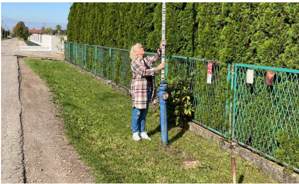
Reper roboczy o nazwie Rp „14” , wysokość repera = 358,47 , zlokalizowany na hydrancie, ulica Zielona, rejon posesji nr 105 –(zgodnie z planem sytuacyjnym)
