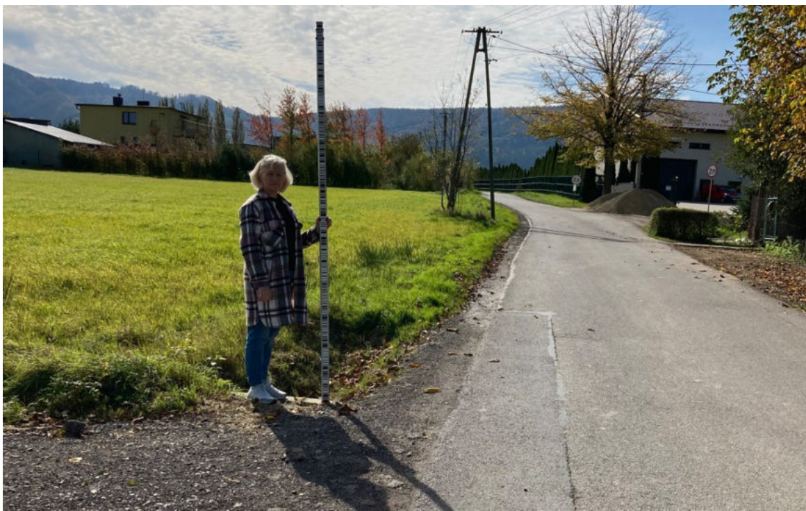
Reper roboczy o nazwie Rp „0” , wysokość repera = 359,50 , zlokalizowany na ścianie czołowej przepustu – ulica Górska (zgodnie z planem sytuacyjnym)
