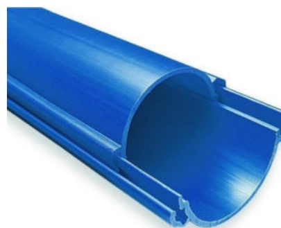
Przykładowa rura osłonowa HDPE SN8 średnicy 110 mm koloru niebieskiego dla kabli NN i oświetlenia ulicznego
