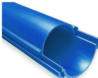
Przykładowa rura osłonowa HDPE SN8 średnicy 110 mm koloru niebieskiego dla kabli NN i oświetlenia ulicznego
